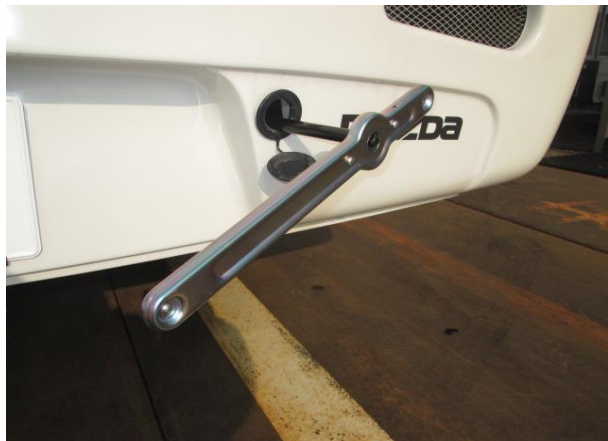
ラチェットをはめて往復運動で回してタイヤをおろします。
