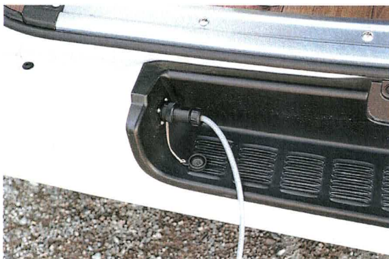
外部電源コンセント
